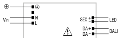
Active DALI diagram Collegamento DALI attivo
