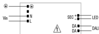
DALI diagram Collegamento DALI
